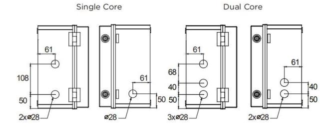
Drilling Guide for 1" Conduit
