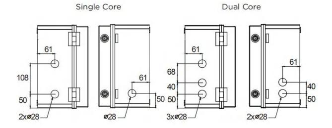
Drilling Guide for 1" Conduit
