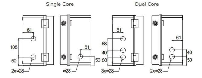
Drilling Guide for 1" Conduit
