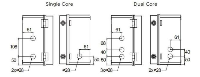
Drilling Guide for 1" Conduit
