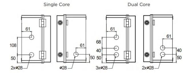
Drilling Guide for 1" Conduit
